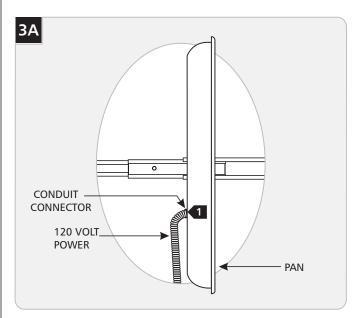
Connect the 120 volt power line conduit to the conduit connector.
